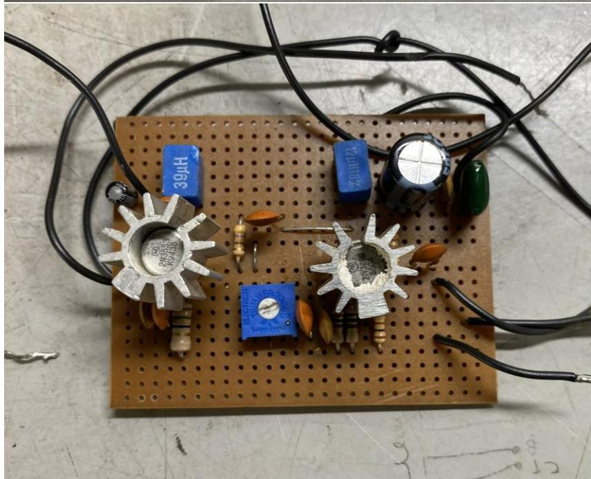
Fique atento ao ajuste no trimpot de 1K para evitar que o circuito auto oscile. A auto-oscilação pode ser percebida devido ao ruído na faixa inteira que você está amplificando.
