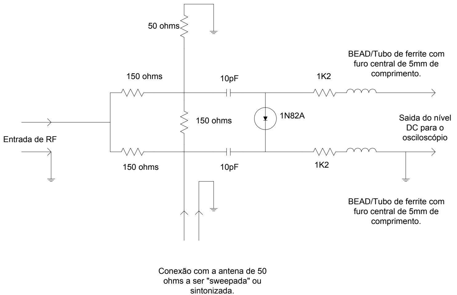
Para usarmos com antenas de 75 ohms, os resistores de 150 ohms devem ser substituídos por resistores de 225 ohms e o de 50 ohms por um de 75 ohms
