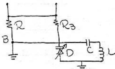
O diodo mais o indutor formam um circuito LC paralelo. Este circuito terá sua frequência de oscilação definida pelo diodo e pelo indutor. Sendo assim, quando variarmos a tensão sobre D (variando também sua capacidade) estaremos mudando a frequência de oscilação do circuito. A variação da tensão sobre o diodo é feita através do cursor de R. Em uma TV este cursor equivale ao eixo que controla a sintonia final.
