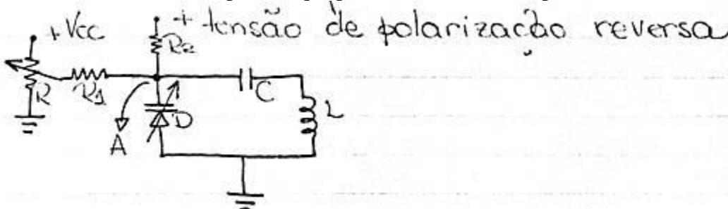
A tensão reversa de polarização possui a função de manter sempre o diodo reversamente polarizado. Desta forma, mesmo que o cursor de R esteja no “terra” o circuito continuará a oscilar.
